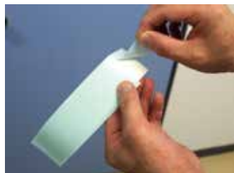
1. 剥離紙の一部を剥がす (剥離紙に切れ目が入っています)
